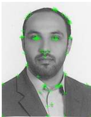
شکل شماره ۲۴: نقاط کلیدی روش FAST (Figure-24) Key points of FAST method
